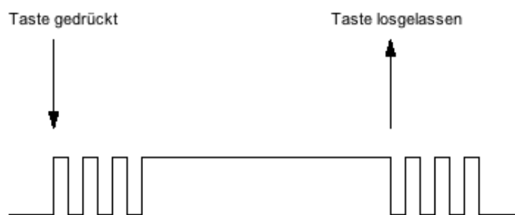
Abbildung 4.12.: Prellen eines mechanischen Kontaktes [37]
